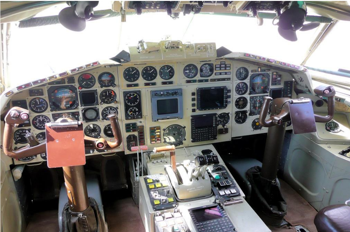
Stanowiska pilotów w polskim Tupolewie 154M. Na kolumnach sterowania widać uchwyty dla kart z instrukcjami do lądowania które normanline zawierają limity dotyczące EU OPS 1.405
